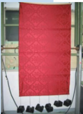
布料超音波加工後，測試情形。5 公斤不能變形，30 公斤不能破壞。
