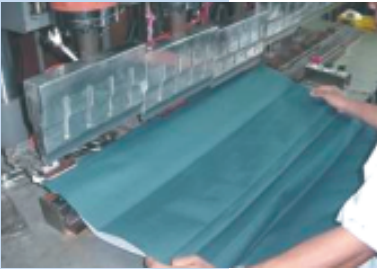
布料超音波加工實驗情形
