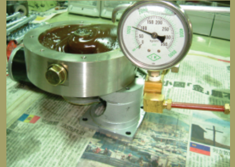
使用板金件測試運轉情形
