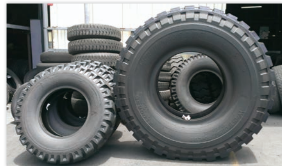
▲一般卡車翻修胎（左）與新開發之 21.00 R35 巨型工程用輪胎翻修胎（右）比較圖。
