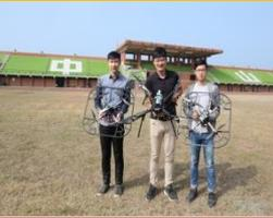
資工系李宗南教授團隊研發偵測空污的智慧無人機群，在無人機加裝「污染感測器」，透過4G行動網路傳輸控制訊號來做超視距遙控無人機群。
